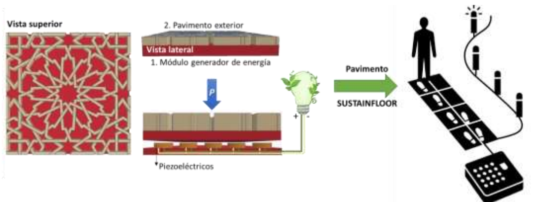
Figura 1. Diseño conceptual del sistema de pavimento generado de energía desarrollado en el marco del proyecto SUSTAINFLOOR
