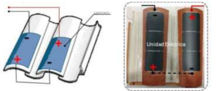
Figura 4 Conexión de las celdas fotovoltaicas sobre el sustrato cerámico curvo (teja cerámica)
