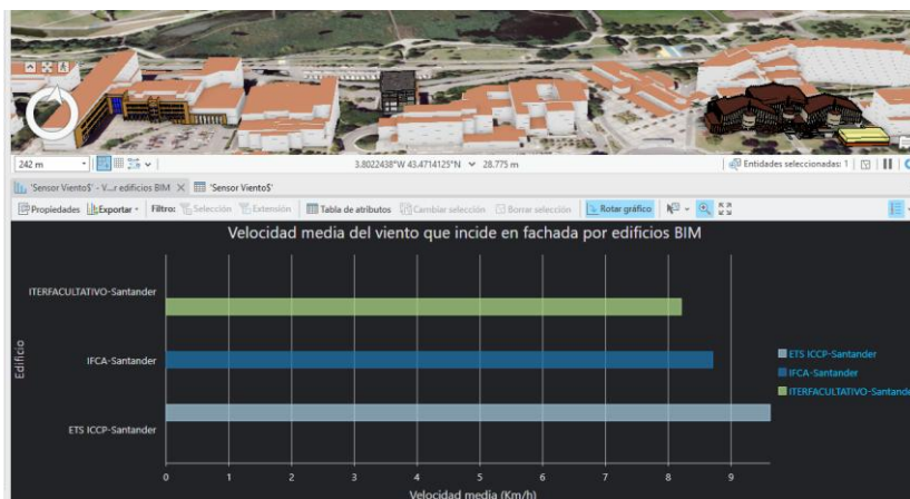
Fig. 15. Simulación de la monitorización de la velocidad del viento que afecta a los edificios
