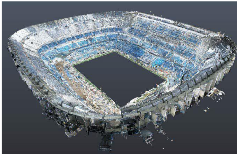
Figura 8. Nube de puntos coordinada del estadio durante la ejecución, base geométrica para la coordinación BIM y para el ajuste de tolerancias entre estructura nueva y existente.
