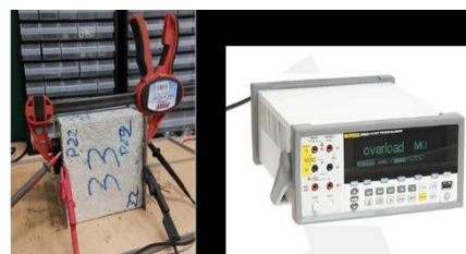
Figura 2. Ensayo de resistividad eléctrica de materiales base cemento.
