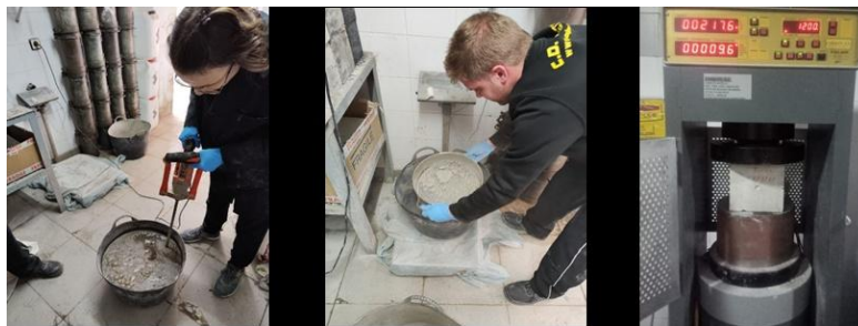
Figura 4. Fabricación y ensayo mecánico de muestras de electrolito sólido base cemento.
