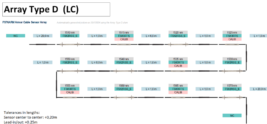
Figura 3. Ejemplo de array FBG empleado para la monitorización de losas
