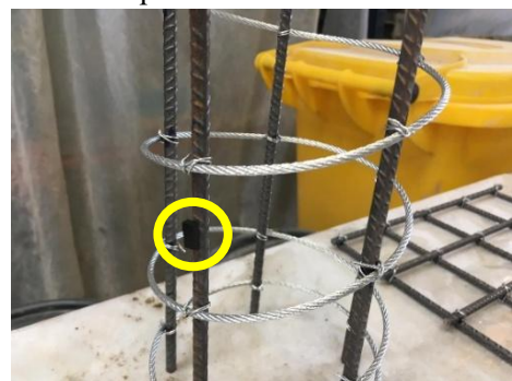
Figura 7. Localización tag RFID dentro del refuerzo cilíndrico
