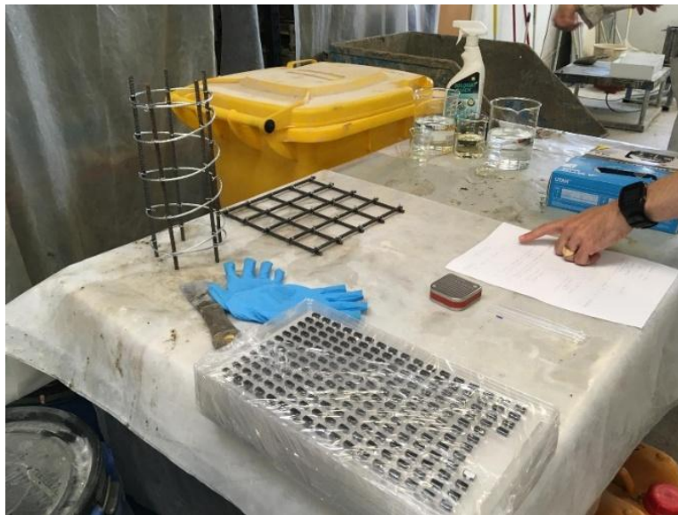
Figura 5. Set-up de laboratorio para validación de tecnología RFID en probetas de hormigón
