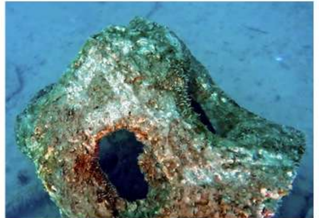
Figura 4. Arrecife artificial fabricado mediante geohormigón sostenible con residuos de construcción y demolición (RCD) instalado en entorno marino mediterráneo para evaluación de comportamiento estructural y colonización biológica.
