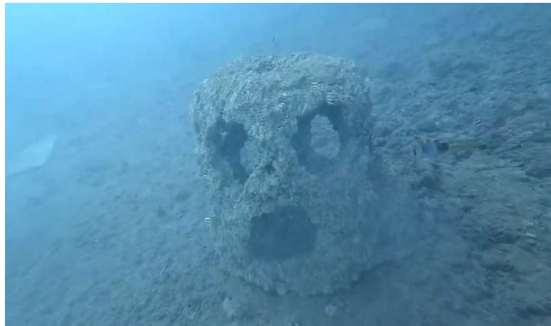
Figura 4. Arrecife artificial fabricado mediante geohormigón sostenible con residuos de construcción y demolición (RCD) instalado en entorno marino mediterráneo para evaluación de comportamiento estructural y colonización biológica.
