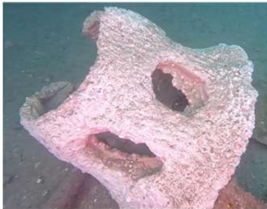
Figura 4. Arrecife artificial fabricado mediante geohormigón sostenible con residuos de construcción y demolición (RCD) instalado en entorno marino mediterráneo para evaluación de comportamiento estructural y colonización biológica.
