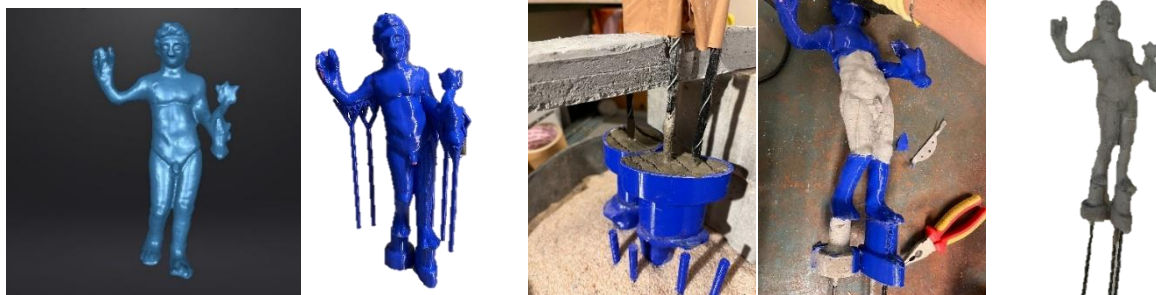
Figura 3. Proceso de fabricación de las esculturas
