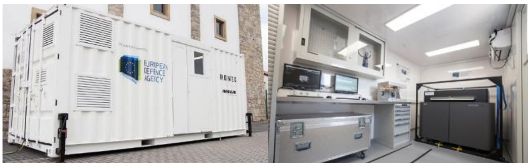
Figura 4. Sistema desarrollado por IDONIAL. Imágenes del exterior e interior de la planta móvil aerotransportable de fabricación aditiva.
