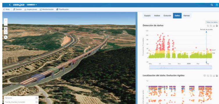
Figura 8. Interfaz de visualización de detección de daños en puente de Huertas de Mateo. Proyecto IAM4RAIL.
