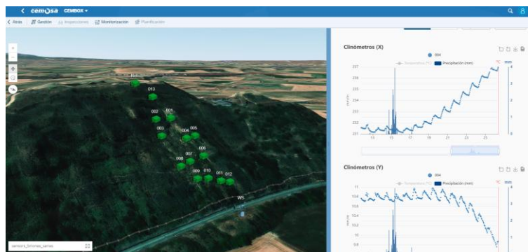
Figura 7. Interfaz de visualización de datos de clinómetro en talud Briones. Proyecto IAM4RAIL.
