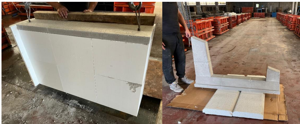
Figura 7. Desmontaje del molde y pieza final obtenida.
