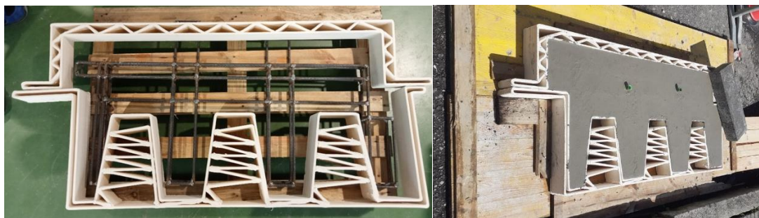
Figura 3. Molde con armadura en su interior (izda). Pieza final tras curado del hormigón (dcha)
