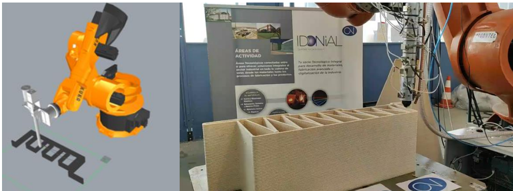
Figura 2. Sistema de fabricación BAAM montado sobre robot fabricando el molde
