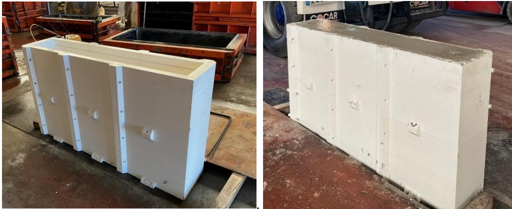
Figura 6. Molde conformado por el ensamblado de las diferentes partes. Vacío (izda) y relleno (dcha) de hormigón.
