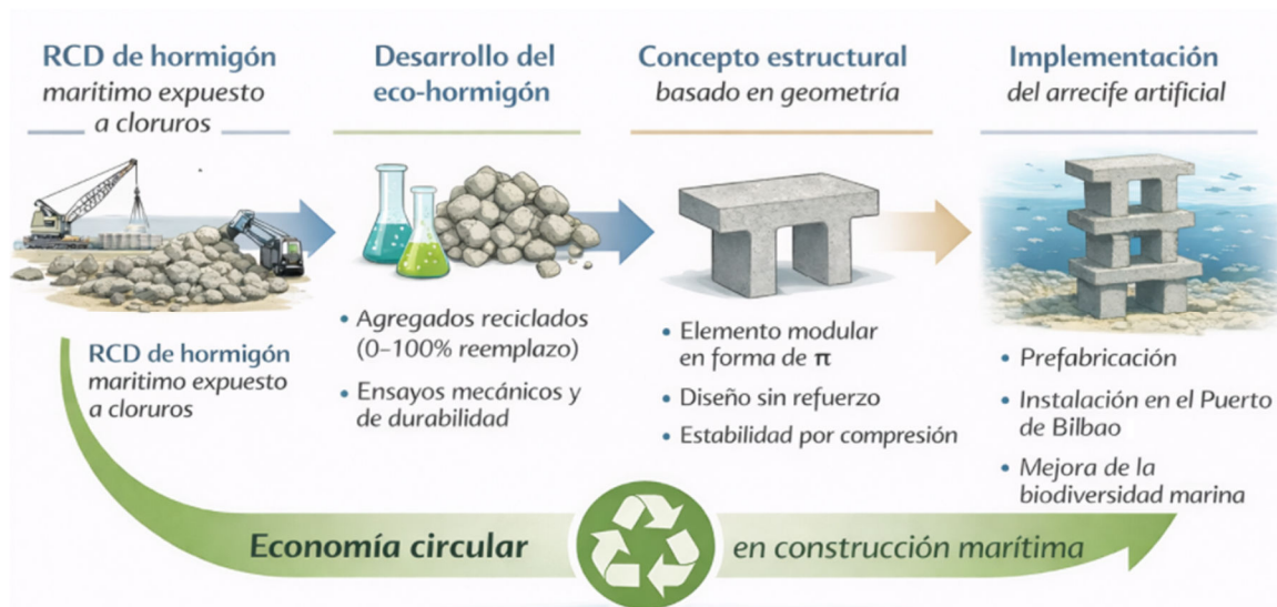
Figura 1. Esquema conceptual del Proyecto SEACOND
