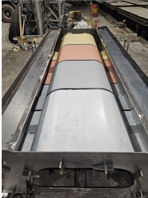
Figura 3. Molde empleado para la fabricación de los módulos de arrecife artificial
